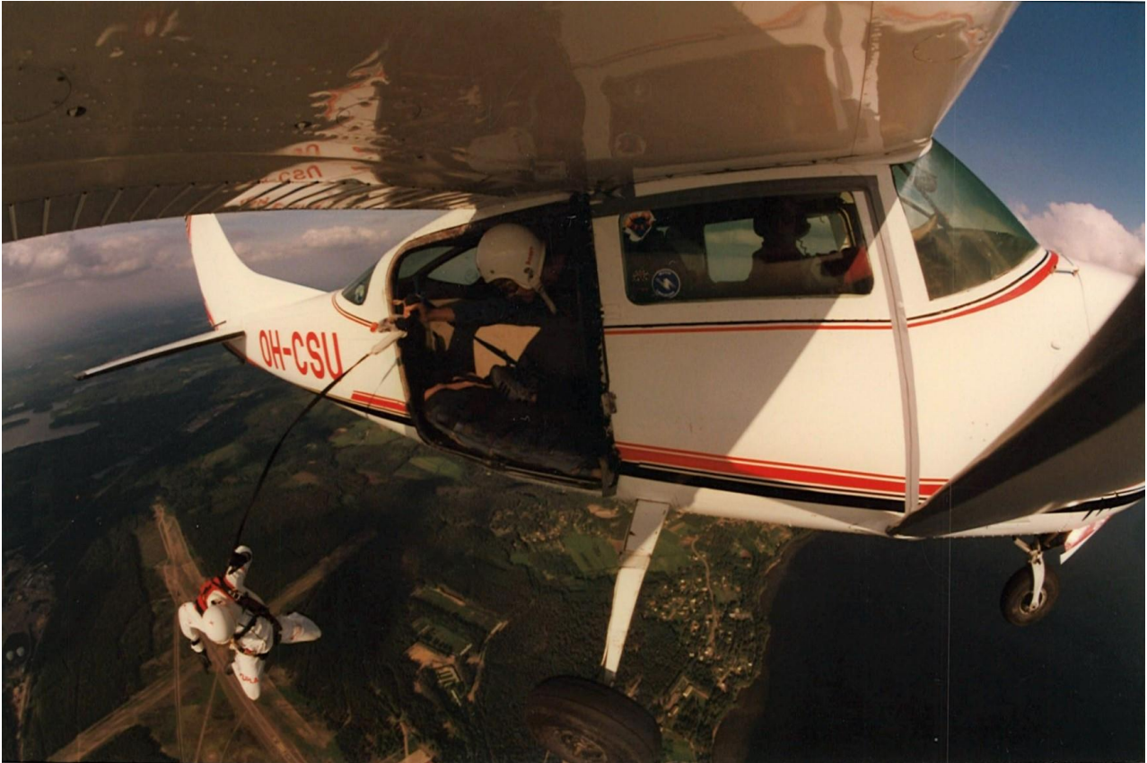
Kuvassa imatralaisten TUMPPU ”in action” Immolan taivaalla tosin vasta seuraavalla vuosikymmenellä, heinäkuussa 1991. Järjestelmä on edelleen alkuperäistä vastaava. Kuvassa oppilaan päävarjon apuvarjo on jo pääosin purkautunut hyppymestari Jussi Laineen kädessä olevasta Tumpusta. Kuvasta saattaisi päätellä, että apuvarjo kävisi lähellä korkeusvakaajaa. Kuvasarjan seuraavan kuvan mukaan ero vakaajaan on hyvinkin riittävä. Hyppääjä on luultavasti Jukka Haukovaara, lentäjä Mika Kanto. Kuva: Jussi Laine
