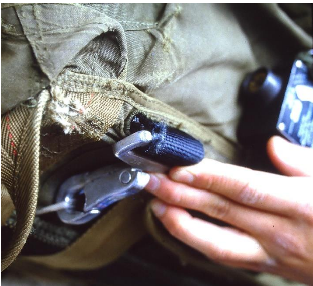
Vasemmassa kuvassa on laskuvarjovarustuksen yhteensopivuuteen liittyvässä tarkastuksessa hylätty rintapakkausvararjo, jonka kantohihna on pahoin kulunut. Oikeassa kuvassa on oppilashyppääjän varustukseen kuuluva puukko [tai vastaava teräase]. Tähän aikaan kokeneet hyppääjät
