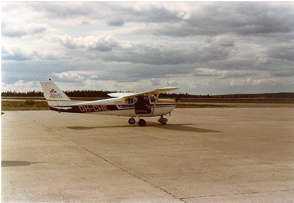
Napapiirin Laskuvarjourheilijoiden harvinaista tyyppiä (Cessna 175 Continental GO-300 moottorilla ja alennusvaihteella) oleva hyppykone OH-CHE. Kuva: Timo Härmä.
