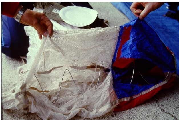
Vasen kuva: rikkoutunut, liian suuri rintapakkausvaravarjon apuvarjo. Oikea kuva: päävarjon kahva, jonka vaijeri oli korvattu epämääräisellä tavalla kahvaosaan kiinnitetyllä pyöreällä muovinauhalla. Kuva: Eero Kausalainen/SIL
