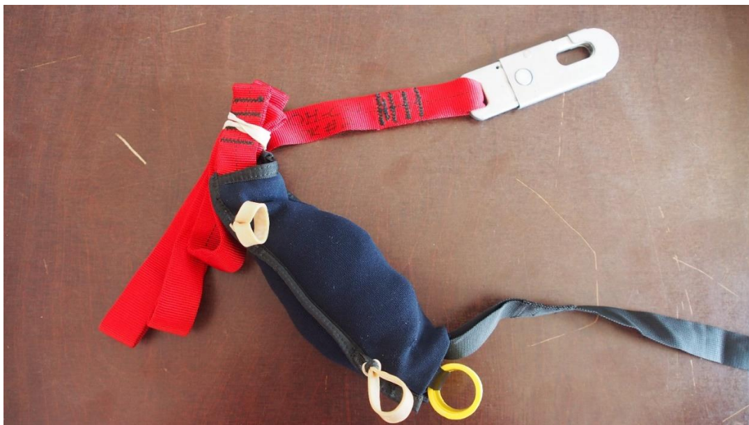
JAD-pakkolaukaisujärjestelmän jatkokehitemä Tumppu, IIK:n Cessna 206 koneeseen (OH-CSU) sovitettuna, mutta kuvattuna 34 vuotta myöhemmin, kesällä 2020. Konstruktio oli edelleen sama kuin vuonna 1986. Kuva: Eero Kausalainen.
