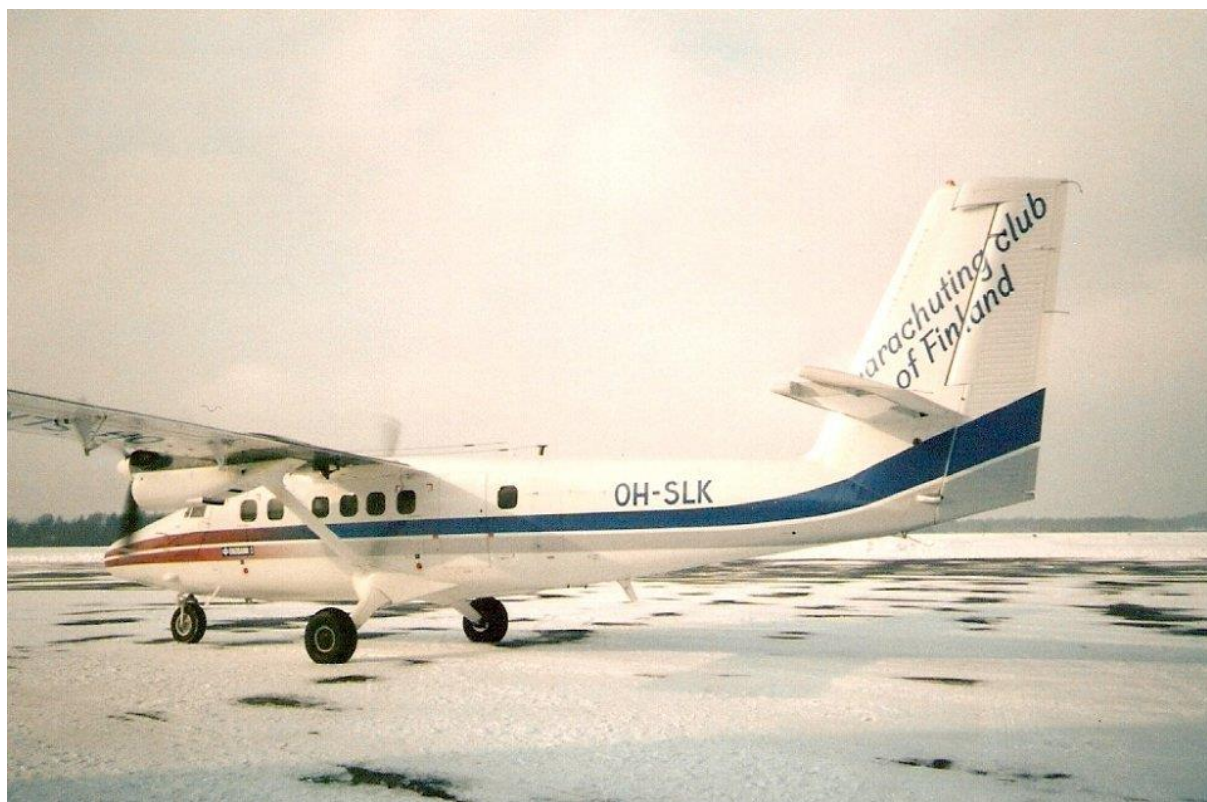
Suomen Laskuvarjokerho vaihtoi vuonna 1988 vanhan Pilatus Porter hyppykoneensa pari numeroa isompaan. Tilalle tuli USA:n hyppykeskuksissa tutuksi tullut DHC-6-300 Twin Otter, OH-SLK. Kerho tuunasi konetta rakentamalla siihen hyp-pyistuimet ja lennolla avattavan oven. Kuva: Lauri Oksanen.
